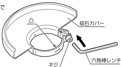
2. 砥石カバーの凸とギヤケースカバーの凹を合わせて砥石カバーをはめ込み、回転させて使用位置に調整後、六角棒レンチでネジをしっかりと締付けます。
