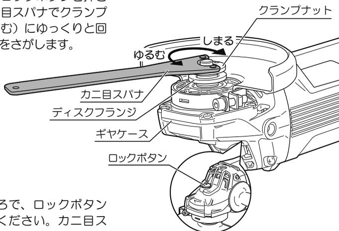
2. ロックが掛かったところで、ロックボタンをしっかりと押さえてください。カニ目スパナを矢印方向（ゆるむ）に回し、クランプナットを外します。
