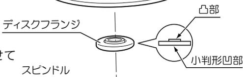
5. 砥石の上からクランプナット（凸部が砥石側）を取付けます。
