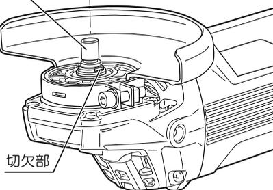
6. ロックボタンを押してスピンドルを固定し、カニ目スパナでクランプナットを締付けます。
