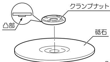
4. 砥石をディスクフランジの凸部に合わせて取付けます。
