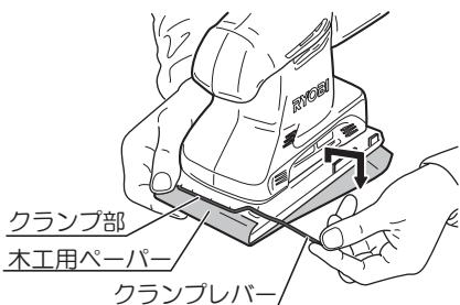
(注) 取付ける前に、木工用ペーパーに図のように折り目を入れておけば取付けが簡単に行なえ、木工用ペーパーのたるみ防止にもなります。
