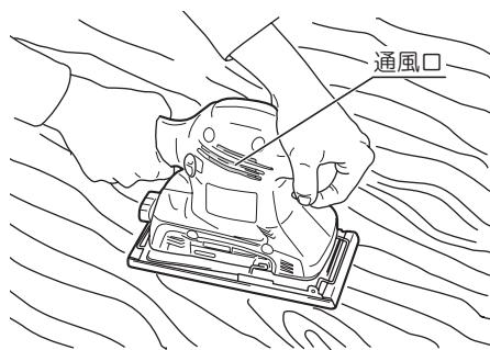
(注) 無理に強く押しつけて作業しないでください。無理に押しつけて研磨すると、均一な仕上げ面が得られないだけでなく、木工用ペーパーの破れや機械故障の原因になります。
