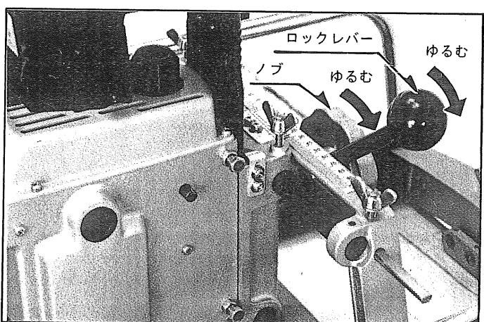
⑤モータークースをストッパーに押しつけてビットの直角出しを行った状態で、ノブを強く締付けて下さい。
