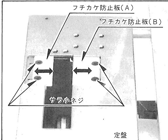
(注意) フチカケ防止板の調整時には、さし込みプラグを電源より外して下さい。
