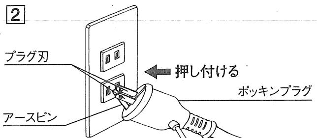
4. ポッキンプラグの後から出ているアースクリップ線をコンセントのアース端子に挟み、接続します。
