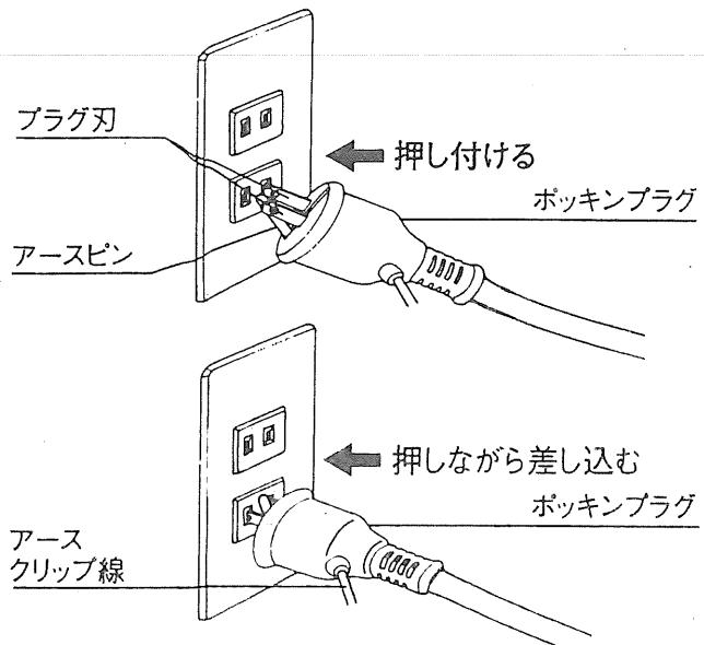
4. ポッキンプラグの後から出ているアースクリップ線をコンセントのアース端子に挟み、接続します。
