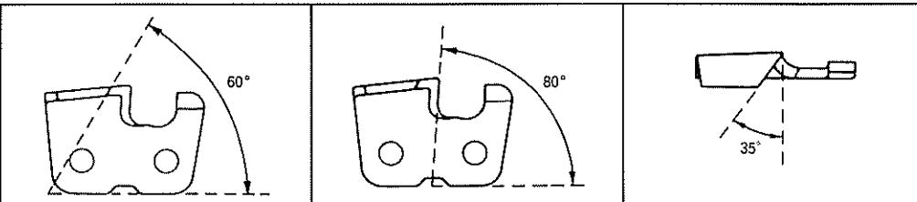
※目立完了後、すべてのカッターについて附属のデプスゲージジョインターを右図のように当てデプスゲージの高さを測定し、ゲージより上にとびだしているときは、平行になるようにすり落してください。
