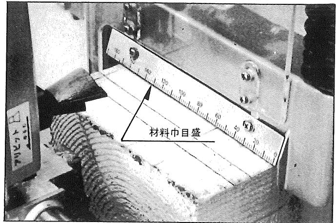
②左右移動目盛の蝶ボルトをゆるめて左右移動目盛をスライドさせ、指針に材料巾寸法を合わせた後、蝶ボルトを締付けて下さい。
