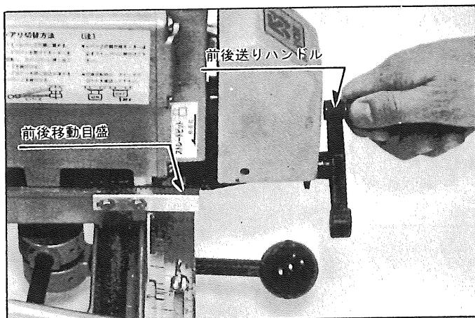
③加工する前には左右送りネジを蝶ボルトで固定し、レバー①(上)、レバー②(下)は必ず強く締付けた状態にして下さい。締付が弱いとビットが振れて正確に加工が出来ないことがあります。
