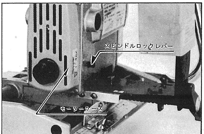
④コレットチャックにビットをいっぱいに差し込み、附属の片口スパナで強く締付けて下さい。締付が弱いと回転中に外れる恐れがあり危険です。
