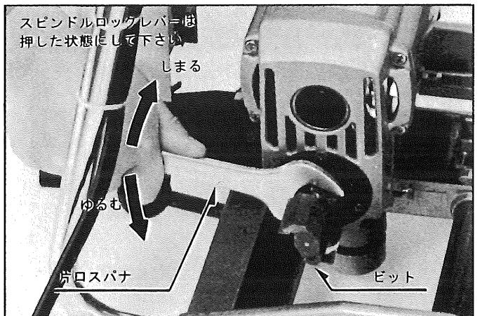
⑤片方のビットの取付が完了しましたらもう一方のコレットチャックに同じ要領でビットを取付けて下さい。(加工材に墨線を引かずに前後移動目盛だけで寸法管理をする場合は、前後移動目盛0位置に於いてアリビットとストレートビットの先端位置を同じに揃える必要があり、ビットを軽く締付けた状態で加工材の端面に前後送りハンドルでビットを押し当てて寸法調整を行なった後、強くビットを締付けて下さい。)
