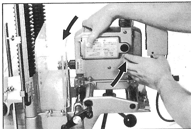
③モーターケースをストッパーに押し当たった状態でレバー②(下)を締付けた後、レバー①(上)を締付けて下さい。
