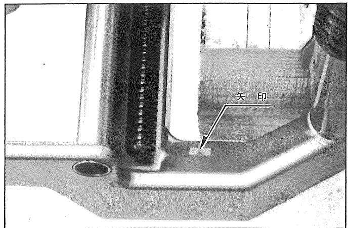
③木材当て面とローラーを加工材に密着させた状態でバイスハンドルを加工材に当たる迄回転させ、バイス締付レバーで締付けて下さい。
