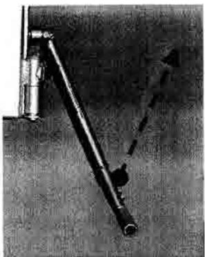
ハンドルを押し込み焼却物を焼却炉内に投入する。
