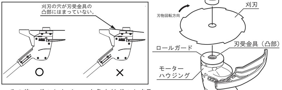
その後、ボルトカバー、六角穴付ボルトを取付けてください。
