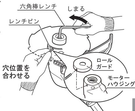
9. 取付け作業が終了したら、六角棒レンチ、レンチピンはハンドルに収納してください。
