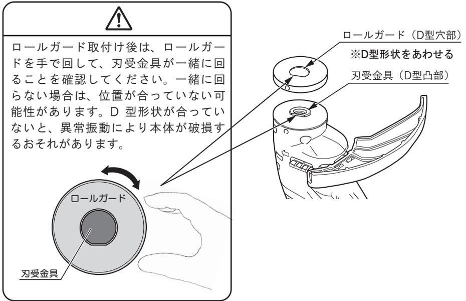
7. 刈刃は文字 (RYOBI) がある面をモーターハウジング側にし、刈刃の穴を刃受金具凸部に合わせて確実に取付けてください。
