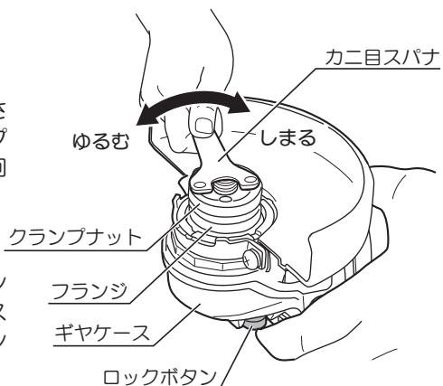
2. ロックが掛けたところで、ロックボタンをしっかりと押さえてください。カニ目スパナを矢印方向（ゆるむ）に回し、クランプナットを外します。
