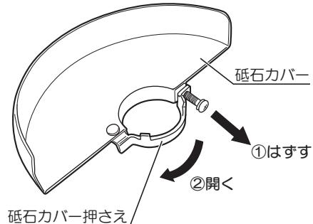
2. 砥石カバーをギヤケースカバーに合わせてはめ込み、ネジをしっかりと締付けます。
