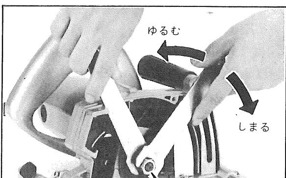
(注意) カッター着脱の時は必ずさし込みプラグを電源より外して下さい。
