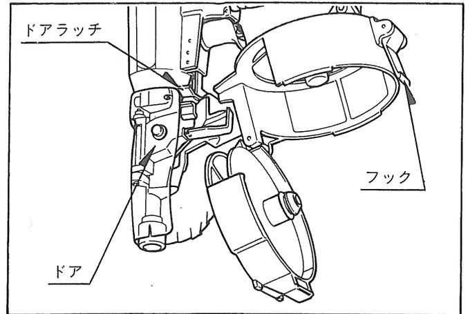
③ 使用するネイルに合わせてネイルサポートの高さを調節します。
