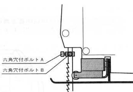
●MJ-21、21Vはバックアップローラー付となっており、ブレードの破損を防止し、スムーズな切断ができます。
