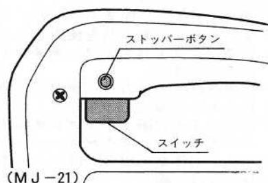
●回転調整ツマミを左に回すと低速回転、右に回すと高速回転がえられます。右に止まるまで回した場合は、スイッチの引き具合により0~3200回/分までの範囲内で、自由に調整できます。(MJ-21V)
