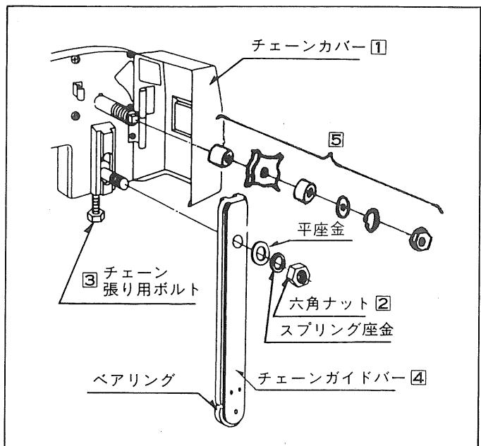
スパナ24mmでスプロケットを固定し、スパナ13mmでナットを締付けた後、チェーン刃の張りを調節して固定します。
