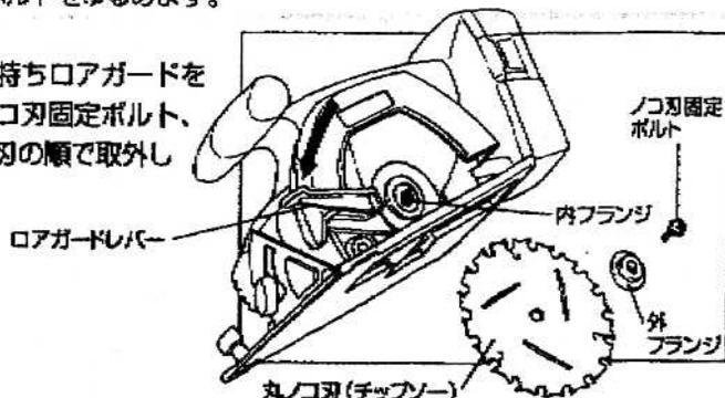
5. 取付けは、内フランジに新しい丸ノコ刃を合わせ外フランジ、ノコ刃固定ボルトの順に取付け、ノコ刃固定ボルトをしっかりと締付けます。
