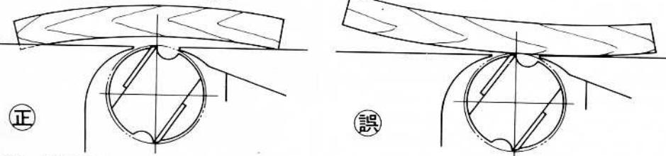
●薄い材料削りは板押し治具を作成して行うと安全に作業出来ます
