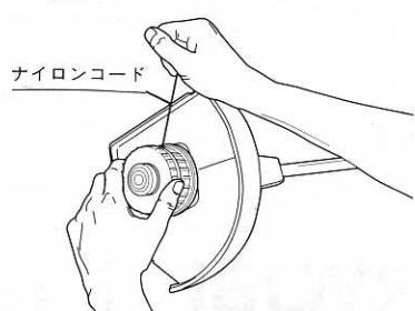
10. スイッチレバーを引いたまま、ナイロンカッターの底面を地面にはずませるように、一度叩き付けて、正常にナイロンコードが出るか確認してください。
