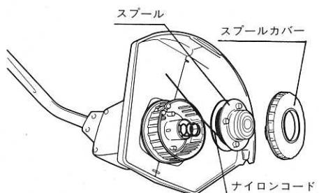
4. ナイロンコードの一端を、スプールの穴に通し、ライターの火などでナイロンコードの先を熱し、何かに押付け、抜け止めとしてください。
