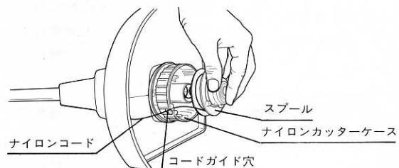
8. ナイロンカッターケースの凹部とスプールカバーの凸部を合わせ、右に回転させ取付けてください。
