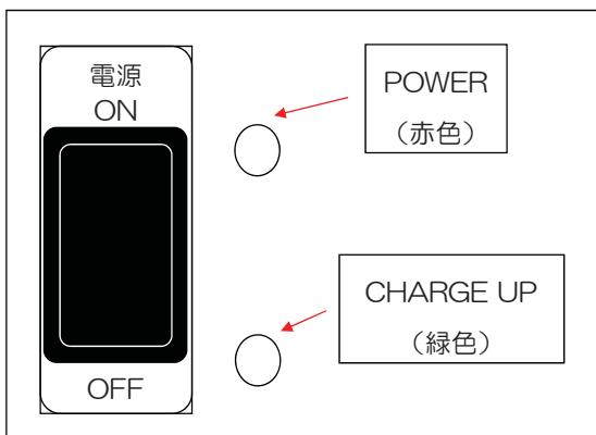
バッテリ充電器は左図及び下表に示す各 LED の点灯状態で充電状態を表示します。
