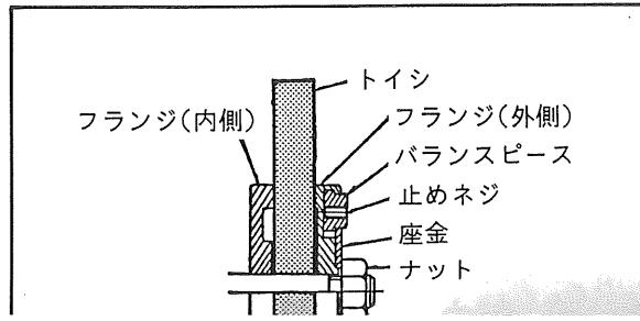
の位置を変更して調整します。バランスが十分とれれば、砥石軸は幾回転しても任意の位置で止ります。
