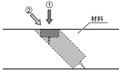
(注) また傾斜切込み時は、本体を下に押付ける方向に力が入り易くなりますので、本体を上に持上げる感じで切込みを行なってください。
