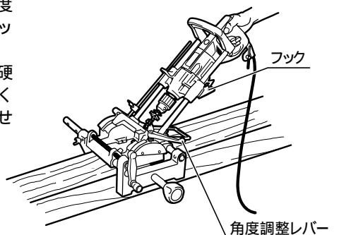
(注) バイスドリルで傾斜穴あけ時に、キリの逃げにより切込みの送りが重くなることがあります。スムーズな穴あけを行なうために、右図のように先に垂直に深さ10mm程度の下穴をあけた後、角度調整をして穴あけを行なうか、のみを打ってキリの先端が逃げないようにして加工をしてください。
