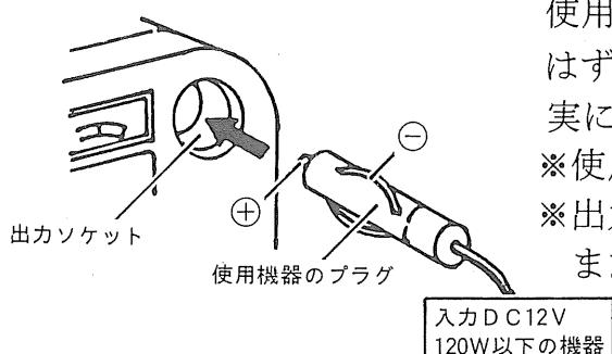
使用機器の電圧と $+$  $-$ の極性をたしかめ、キャップをはずしてから、使用機器のプラグを出力ソケットに確実に差し込んでください。
