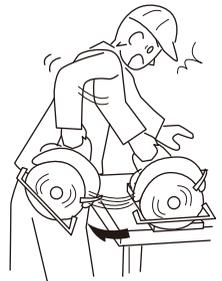
11. 誤って落としたり、ぶつけたときは、工具類（ノコ刃など）や本体などに破損や亀裂、変形がないことをよく点検してください。
