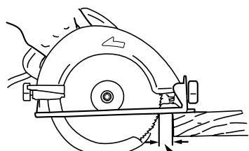
木材に定盤面を乗せ、ノコ刃が木材に当たらない程度の隙間を開けてください。
