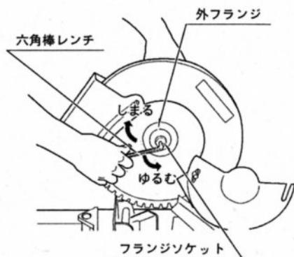
④取付けは、取外しと逆の要領で行ないます。この時チップソーの向きと機械の回転方向に十分注意してください。
