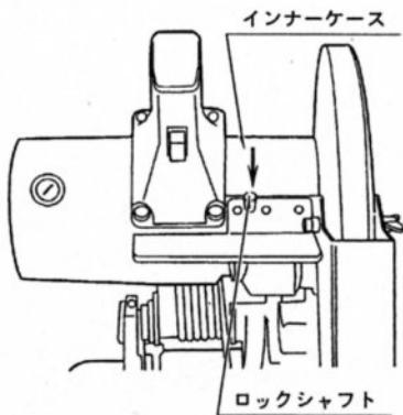
③付属品の六角棒レンチでフランジソケットをゆるめます。補助カードを押し上げて、フランジソケット、外フランジ、チップソーの順に外します。
