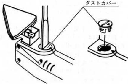
4. ダストノズルの凸部を本体のダスト穴凹部に合わせさし込みます。
