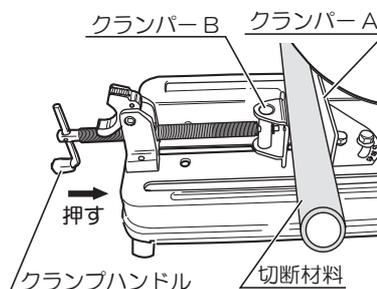
4. ロックレバーを矢印方向に起こし（ネジ部が下向）、クランプハンドルを矢印（締まる）方向に回してクランパー B で材料を締付けます。
