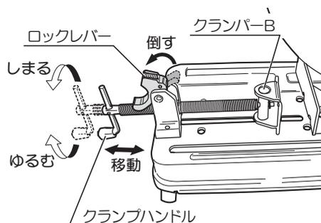
2. クランパー A、B の間に切断材料を置きます。
