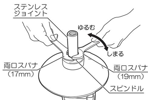
2. ステンレスシャフトをステンレスジョイントにねじ込み、付属品のスパナで締付けます。
