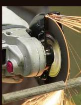
1.0mmの薄刃により、バリ、焼け込みが少なく、軽いタッチと鋭い切り込みで軽快に切断作業が行えます。
