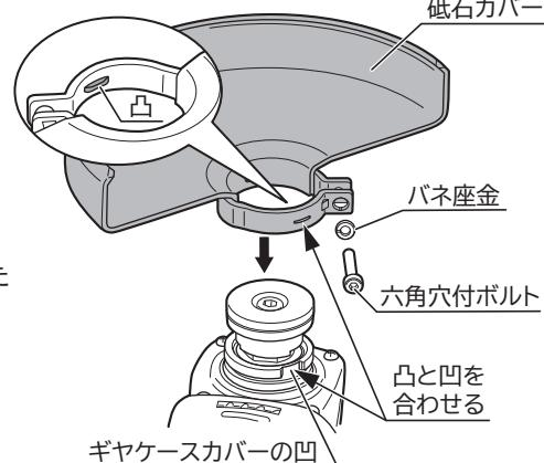
【2】 砥石カバーを回転させて作業に適した角度に合わせてください。
