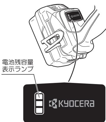
※ 18V工具に、**DUAL VOLT**（デュアルパワーボルト）電池パックを取り付けた場合、18V工具本体と電池パックにある表示に若干の差が生じる場合があります。
